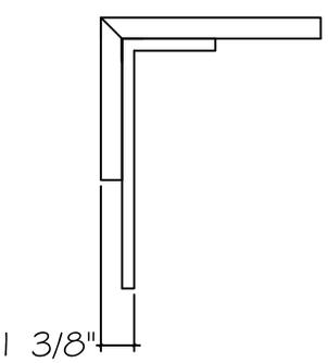
\* Ce coin est utilisé avec les panneaux d'une hauteur de 12" seulement (R-DS-PN-4812).
